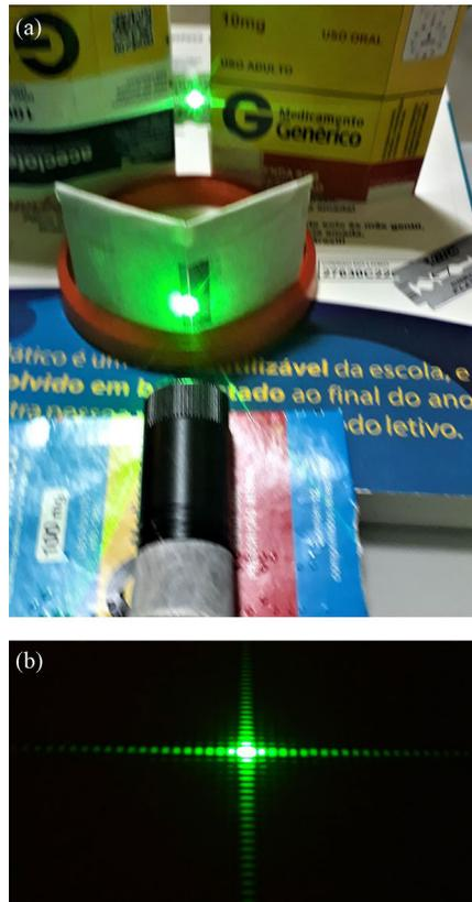
Figura 8 - a) montagem para difração com fendas ortogonais de gilete; b) imagem da difração com fendas ortogonais de gilete.
