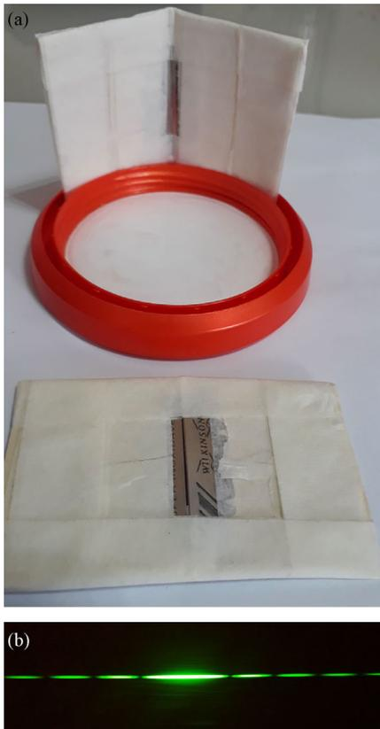
Figura 7 - a) montagem para difração com lâmina de barbear; b) imagem da difração por fenda simples de gilete.
