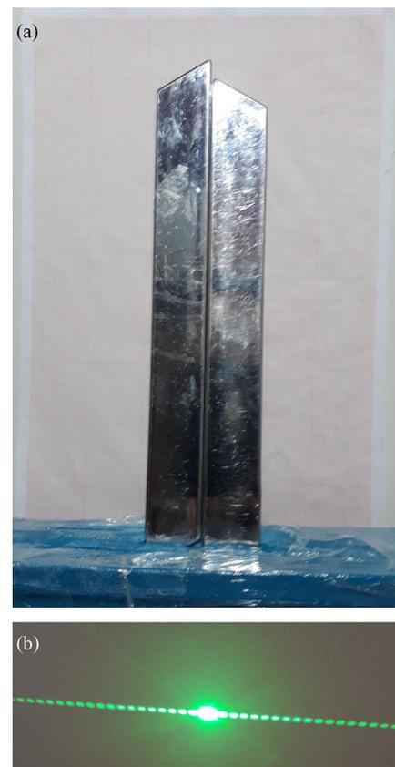
Figura 5 - a) montagem de fenda única para estudo da difração; b) imagem de difração por fenda simples.
