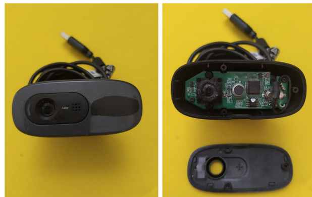
Figura 1 - À esquerda, webcam Logitech C270. À direita, webcam aberta.
