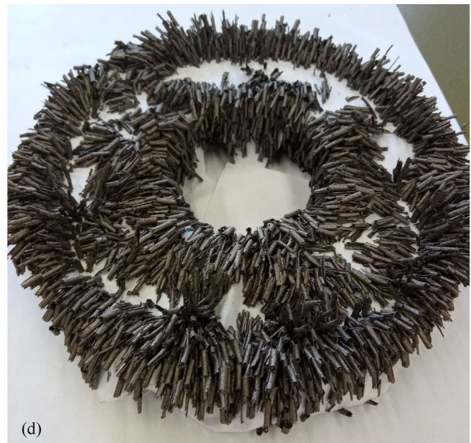
Figura 3 - a) Peça imantada em forma de rosca; b) e c) desenhos das linhas de campo magnético para a peça, d) linhas de campo magnético obtidas com as limalhas de ferro.
