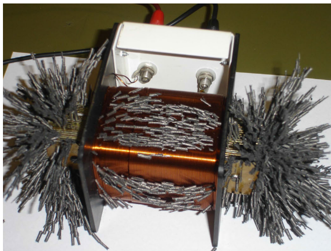
Figura 5 - a) Linhas de campo magnético de um eletroímã obtidas com as limalhas de ferro, b) desenho das linhas de campo.
