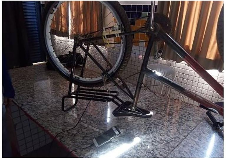
Figura 5 - Carregamento do celular utilizando o dispositivo confeccionado pelos discentes.
