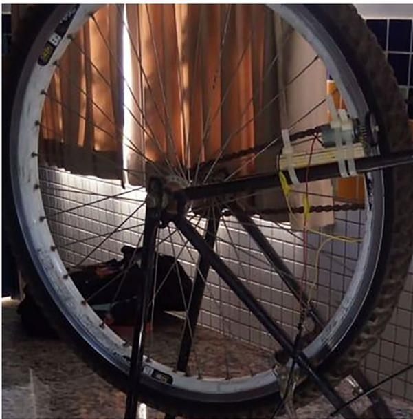
Figura 4 - Motor elétrico fixado na plataforma de madeira acoplado na roda traseira.
