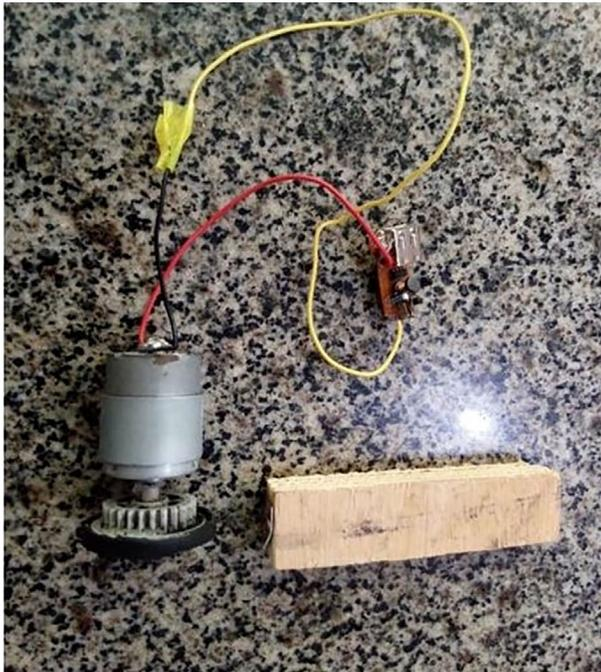
Figura 3 - Motor elétrico da impressora conectado ao carregador de celular veicular USB. Peça de madeira utilizada para fixar o conjunto à parte traseira do quadro da bicicleta.
