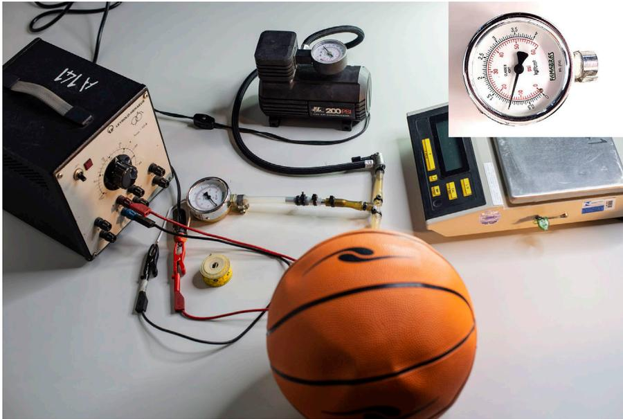
Figura 2 - Equipamento empregado para a obtenção dos resultados apresentados neste artigo. Uma ampliação do manômetro empregado nas medições é apresentada no canto superior direito.
