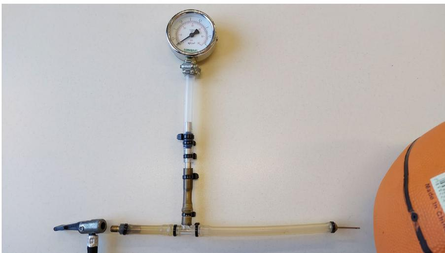
Figura 3 - Montagem para o acoplamento simultâneo do compressor, do manômetro e da bola de basquete. Se for utilizado o manômetro do compressor, um segmento de mangueira será suficiente, com a válvula de ar em uma extremidade e o bico de inflar na outra.
