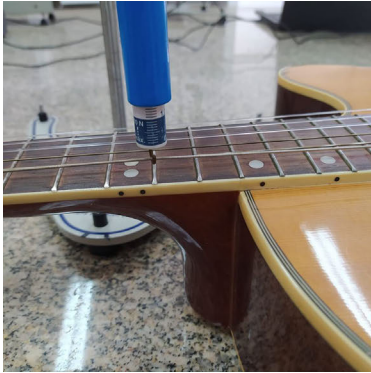
Figura 2 - 6ª corda do violão equilibrada em seu ponto médio (12º traste) com o dinamômetro ao lado do diagrama utilizado para determinar a relação entre a altura da corda e a força aplicada pelo aparelho.
