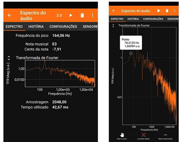
Figura 4 - Espectro do áudio captado pelo microfone do smartphone e harmônicos da nota Mi da 6ª corda. Ambas as imagens apresentam a interface do aplicativo Phyphox.
