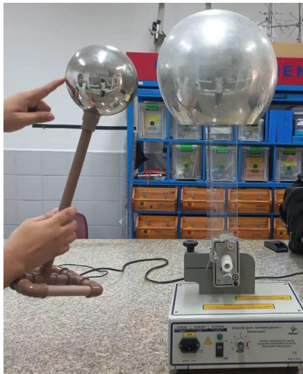
Figura 2 - Após contato com o dedo (aterramento), a esfera terá carga de sinal oposto ao da carga presente na cúpula do gerador de Van de Graaff.
