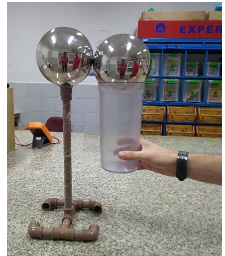
Figura 3 - Após o contato entre duas esferas condutoras, a carga elétrica é distribuída entre elas.
