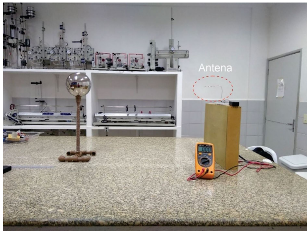
Figura 6 - Aparato experimental: esfera condutora carregada e eletroscópio eletrônico.
