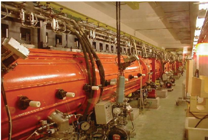
Figura 1 - Foto do LINAC 2 (Acelerador de Partículas Linear).
