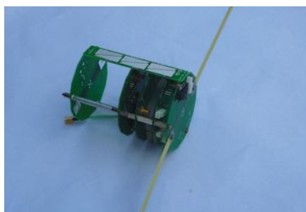
Detalhe da montagem do transmissor de um TubSat típico.
