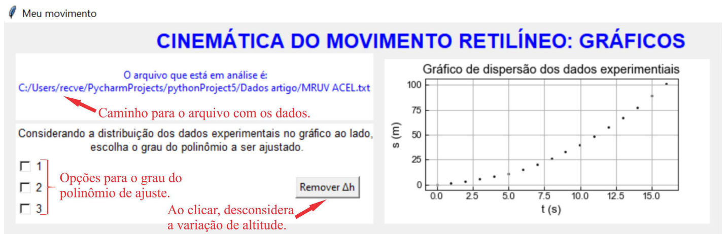
Figura 4 - Parte da tela do programa de análise mostrando o caminho para o arquivo, o gráfico de dispersão dos pontos experimentais e a caixa que permite escolher o grau do polinômio a ser ajustado aos dados.
