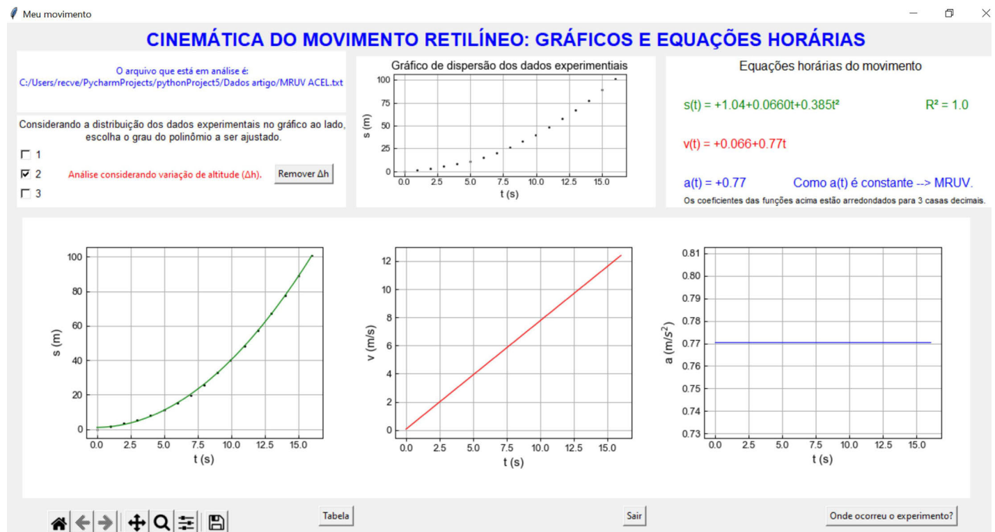
Figura 5 - Painel completo do programa Meu Movimento mostrando o conteúdo da Fig. 4 acrescido dos gráficos do movimento e das respectivas equações horárias determinadas a partir da curva de ajuste das posições em função do tempo.
