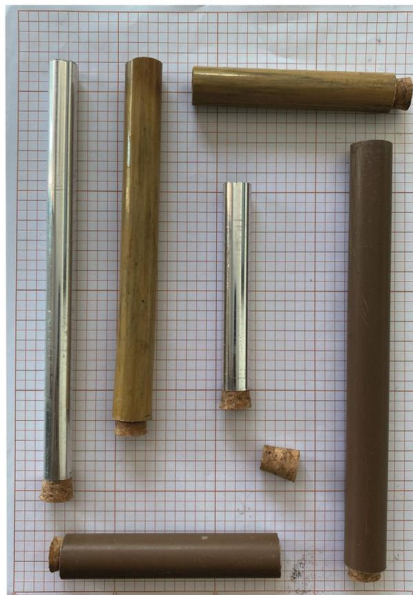
Figura 2 - Flautas de bambu, PVC e alumínio com diferentes comprimentos.
