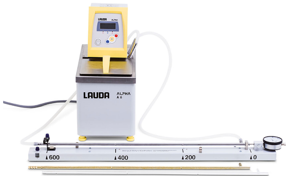
Figura 2 - Dilatômetro com aquecimento por banho térmico. Fonte: http://www.3bscientific.com/de/experiment-thermische-ausdehnung-fester-koerper-230-v-5060-hz-8000577-ue2010130-230-3b-scientific,p_1413_28052.html . Acesso em: 1 fev. 2022.
