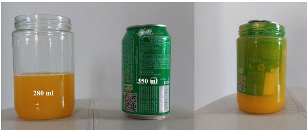
Figura 8 - Demonstração do Paradoxo Hidrostático de Galileu.
