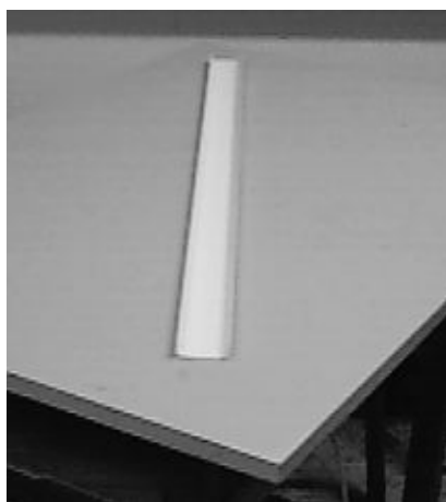
Figura 1: Parte lisa da canaleta cortada para ser utilizada como base para o trilho óptico.
