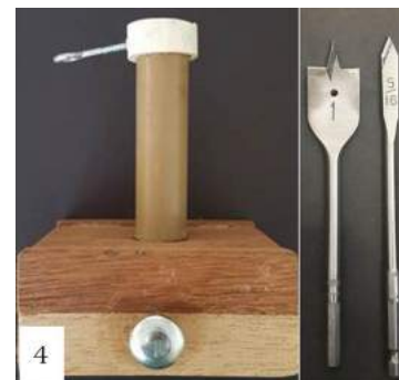
Figura 4 - Visão lateral da peça suporte de lentes e acessórios, contendo parte do que está apresentado de forma individualizada na Fig. 3. Observam-se (de baixo para cima): peça lateral , parafuso francês , base retangular , tubo PVC marrom , tubo PVC branco - 1 , parafuso pitão . À direita observam-se as duas brocas chatas utilizadas nesse trabalho com furadeira vertical de bancada . A broca da esquerda (1 in - uma polegada) é utilizada para furar a região central da base retangular, visando a adaptação do tubo PVC marrom ; a da direita (5/16 in) é utilizada para realizar o furo para posterior formação da rosca para o parafuso francês , o que é realizado durante a inserção do parafuso, ao forçar sua rotação com um alicate. A denominação das peças em itálico é semelhante ao que está descrito na Tabela 1.
