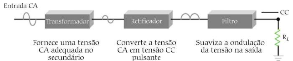
Figura 1 - Componentes de uma fonte de alimentação. Fonte: Adaptado de Malvino e Bates [6].
