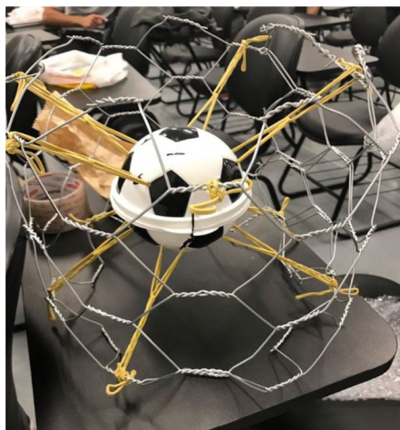
Figura 1 Dois protótipos para a cápsula, utilizando arames e elásticos (à esquerda) e um envoltório de espumas (à direita).
