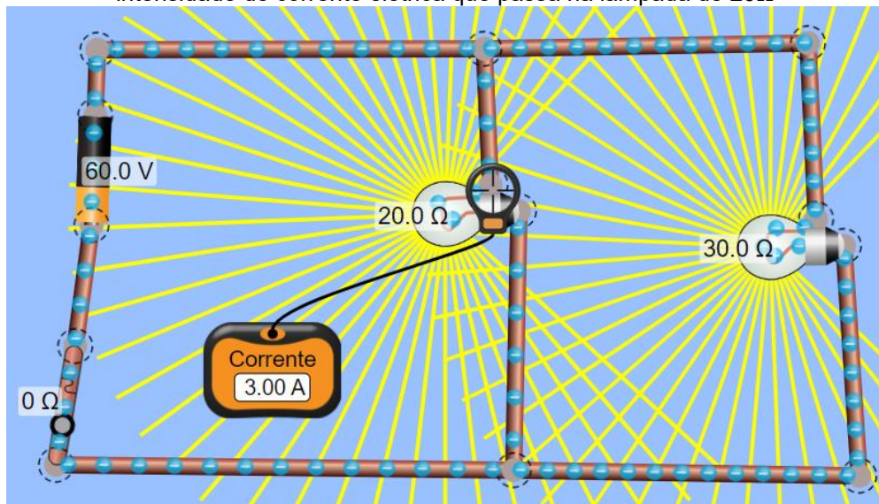
Figura 28: Circuito elétrico simples com lâmpadas associadas em paralelo, com medida da intensidade de corrente elétrica que passa na lâmpada de 20\Omega
