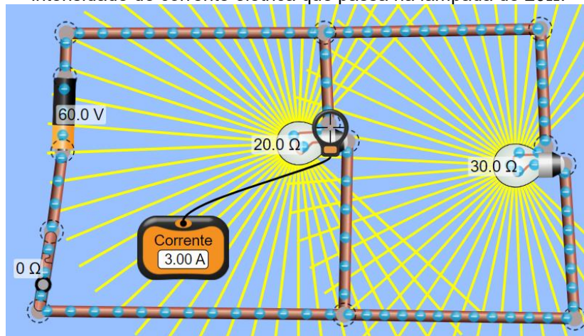
Figura 10: Circuito elétrico simples com lâmpadas associadas em paralelo, com medida da intensidade de corrente elétrica que passa na lâmpada de 20\Omega .
