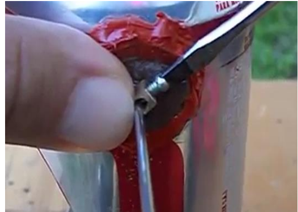
Figura 90: Virabrequim com o conector de fio de luz sendo encaixado no suporte do volante.
