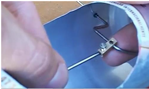
Figura 98: Fixação do raio ao virabrequim com o conector de fio de luz.
