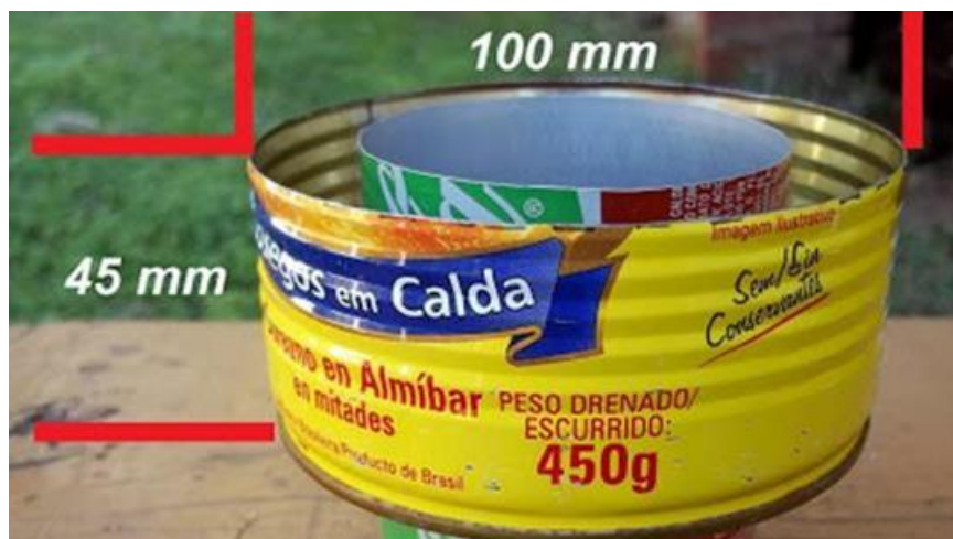
Figura 16: Medidas do Cilindro de resfriamento sem a lâmina de vidro.
