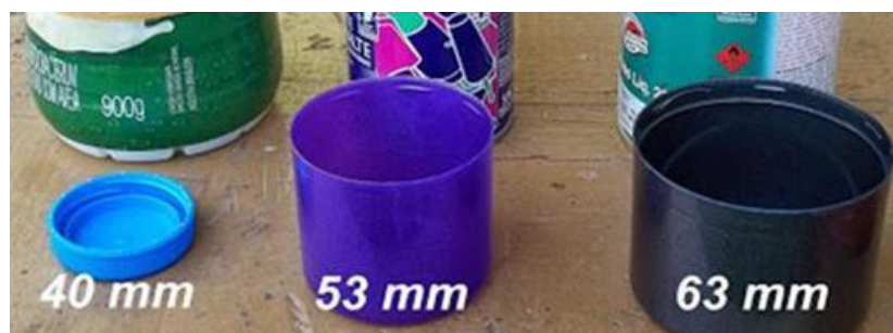
Figura 25: Tampas necessárias para o pistão de trabalho.
