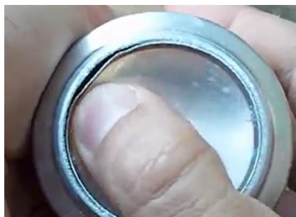
Figura 75: Forma de retirar o fundo da lata
