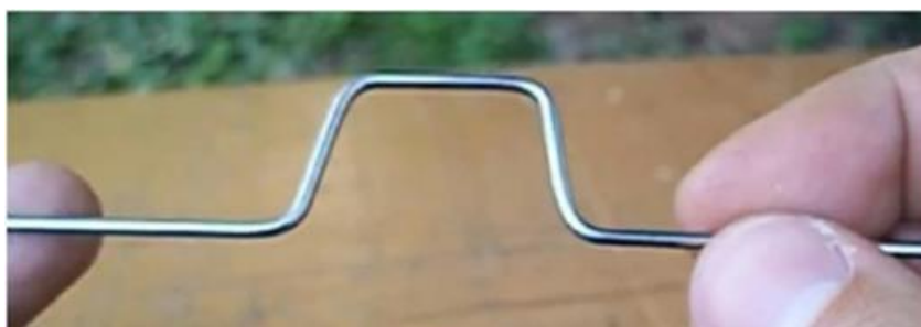
Figura 84: Formato do raio após a quarta dobra.
