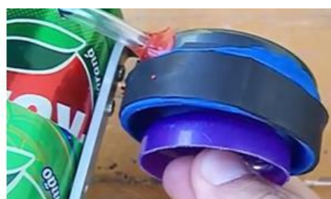
Figura 47: Puxando o pistão para verificar se não há fugas de ar.
