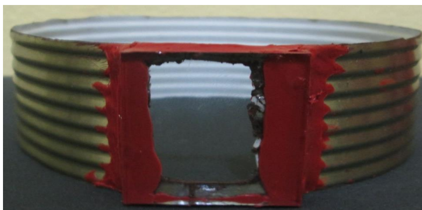
Figura 23: Tira de metal para evitar que o cilindro de resfriamento aqueça já com a lâmina de vidro.
