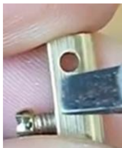
Figura 93: Furo de 3 mm na lateral do conector de fio de luz.
