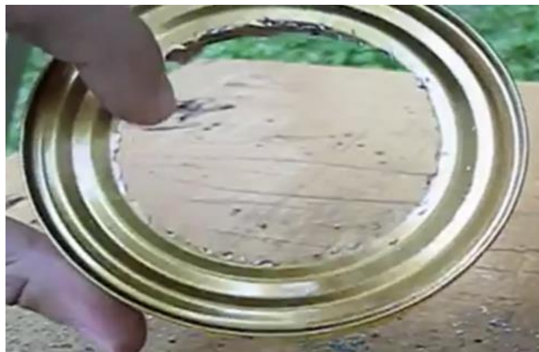
Figura 21: Fundo do Cilindro de resfriamento onde será encaixado o cilindro de aquecimento.
