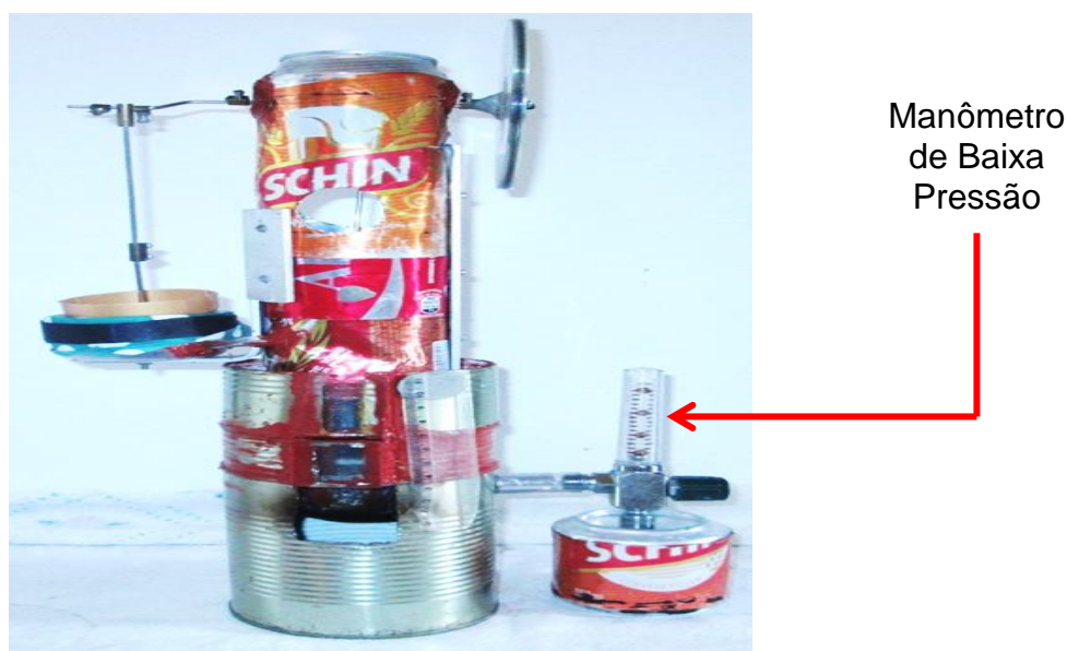
Figura 11: Segundo protótipo do Motor Stirling com o manômetro para pequenas pressões.
