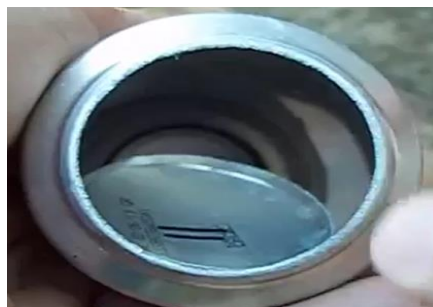
Figura 75: Forma de retirar o fundo da lata
