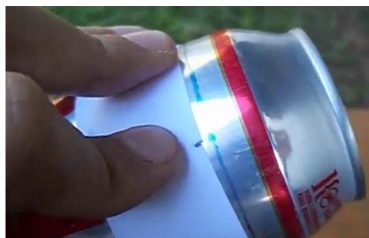
Figura 74: Tira de papel para marcar a posição dos furos.
