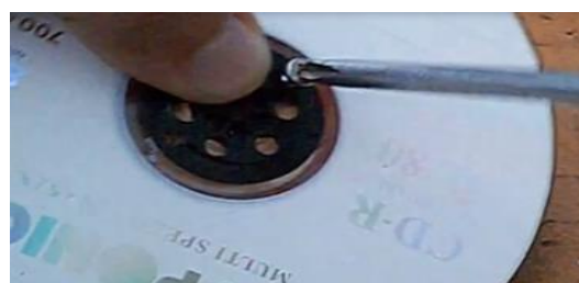
Figura 117: Parafusando o gravador de CDs/DVDs.
