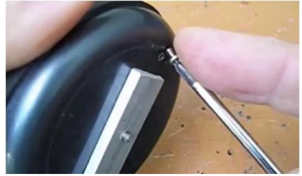
Figura 42: Colocando o parafuso no fundo da tampa do cilindro.
