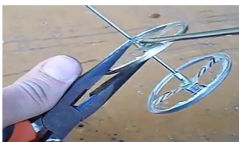
Figura 66: Apertando o conector de fio de luz.
