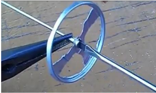
Figura 60: Encaixe da tampa de lata com o parafuso para raio de bicicleta.
