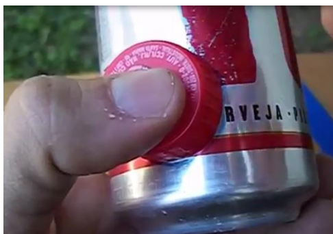
Figura 78: Fazendo o orifício na parte oposta ao brasão.
