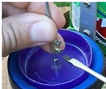
Figura 107: Encaixe do conector do fio de luz no pistão de trabalho.
