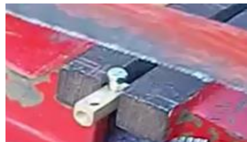
Figura 63: Forma de cortar o conector de fio de luz.
