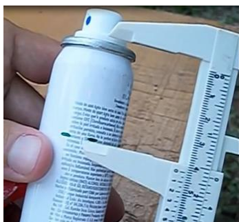
Figura 120: Medida da altura da lamparina.
