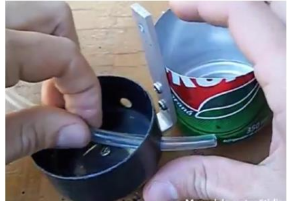
Figura 39: Marcação do cabeçote, para passar a mangueira.
