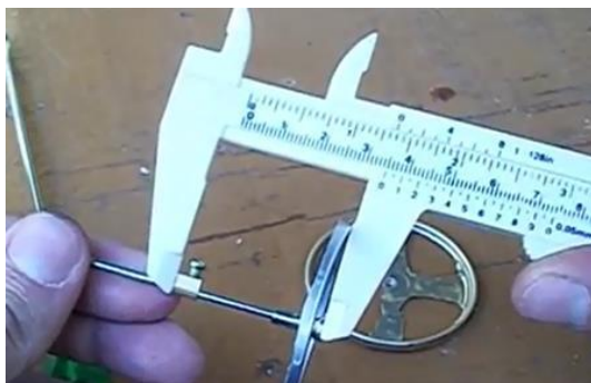
Figura 64: Medida do pistão deslocador de ar.
