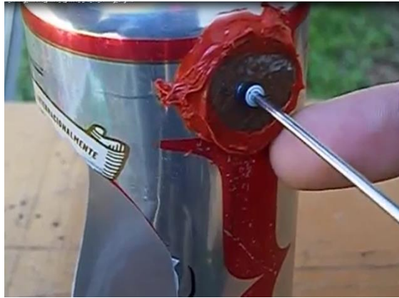
Figura 90: Virabrequim com o conector de fio de luz sendo encaixado no suporte do volante.
