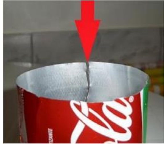
Figura 14: Rompimento do cilindro, ao encaixar o cabeçote.
