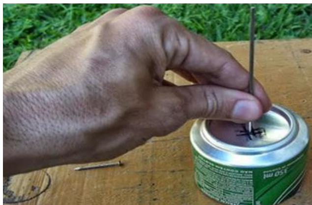
Figura 8: Forçando a passagem do raio de 2 mm de diâmetro.
