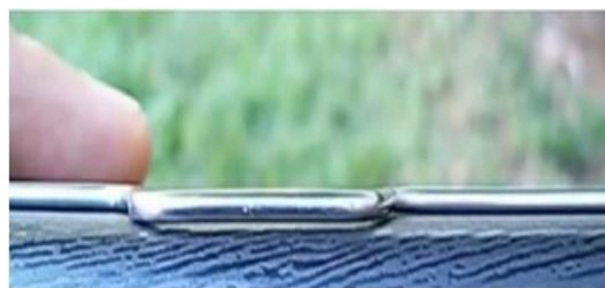
Figura 86: Teste deitado do alinhamento do raio.
