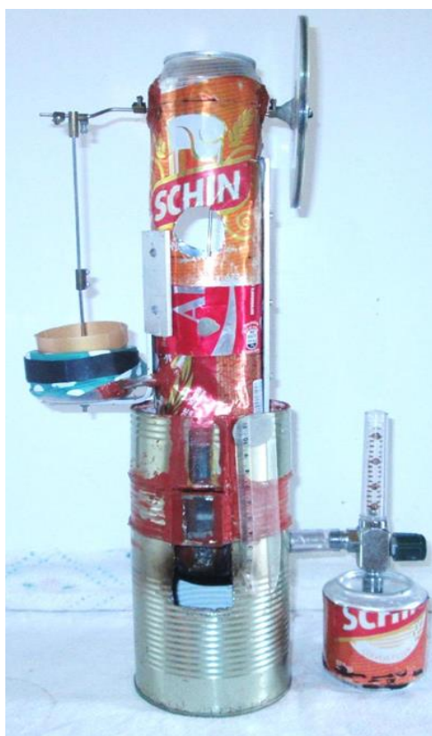
Figura 5: Protótipo do Motor Stirling construído pelos alunos.
