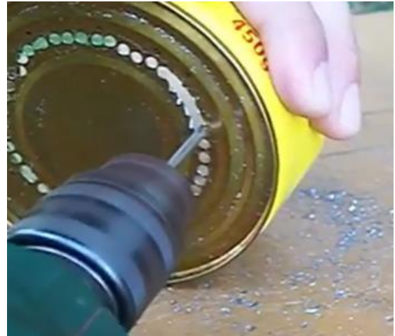
Figura 20: Abertura feita com a furadeira para retirar o fundo do Cilindro de resfriamento.
