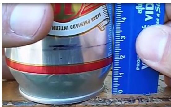
Figura 73: Altura dos furos.
