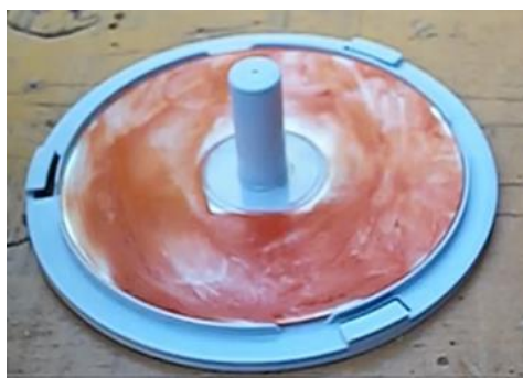
Figura 111: Colando os CDs/DVDs, alinhando com o suporte.
