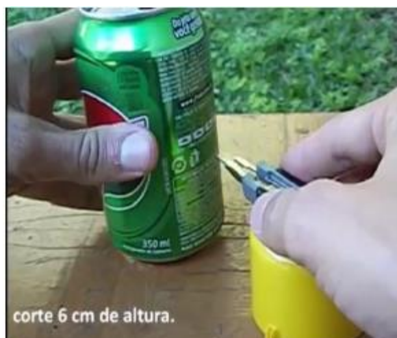
Figura 3: Corte da lata para o cabeçote com o estilete.
