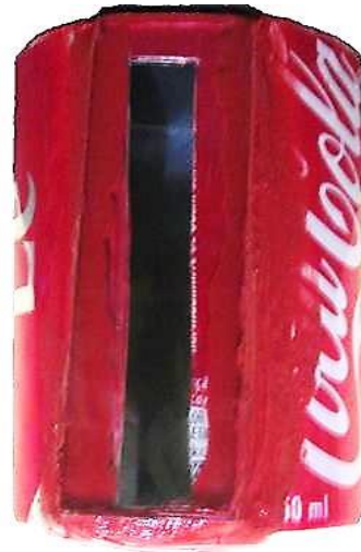
Figura 15: Cilindro quente com a lâmina onde será possível ver o êmbolo se movendo.
