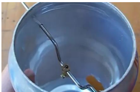
Figura 89: Virabrequim encaixado na lata de suporte.
