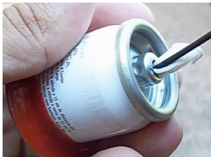
Figura 126: Encaixando o pavio na lamparina.
