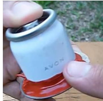
Figura 125: Colando a placa de alumínio na lamparina.
