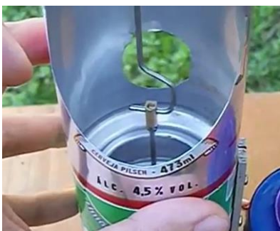
Figura 96: Encaixe do pistão ao virabrequim.
