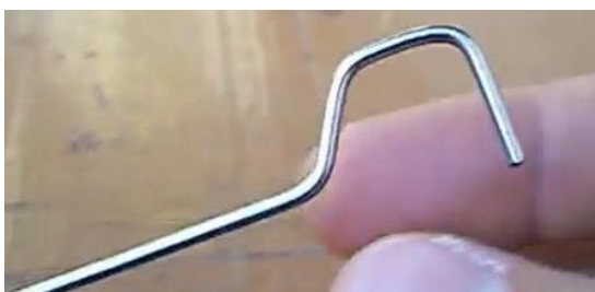
Figura 95: Forma do raio de bicicleta que ligará o pistão ao virabrequim.
