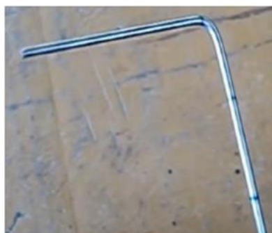
Figura 81: Formato do raio após a primeira dobra.
