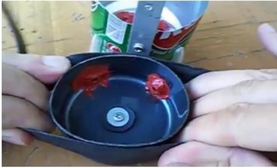
Figura 41: Encaixando a tira de borracha lateral externa da tampa.
