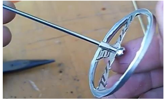
Figura 61: Fundo do pistão deslocador de ar.
