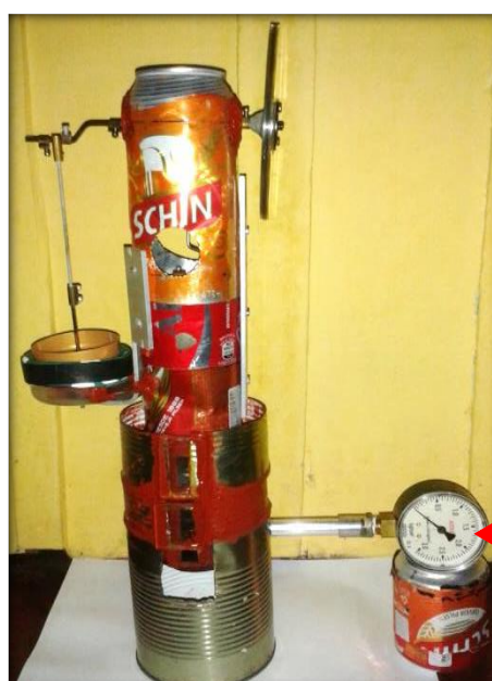
Figura 10: Segundo protótipo do Motor Stirling com o manômetro para grandes pressões.
