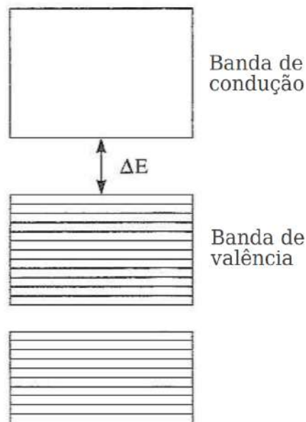
Figura 19 – Bandas de energia de um material Isolante
