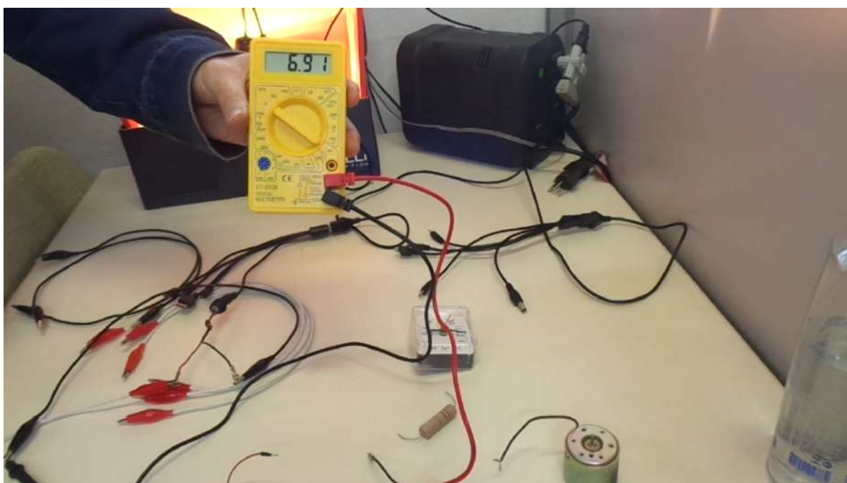
Figura 46 – Tensão elétrica em circuito sem carga gerada pelo outro módulo fotovoltaico
