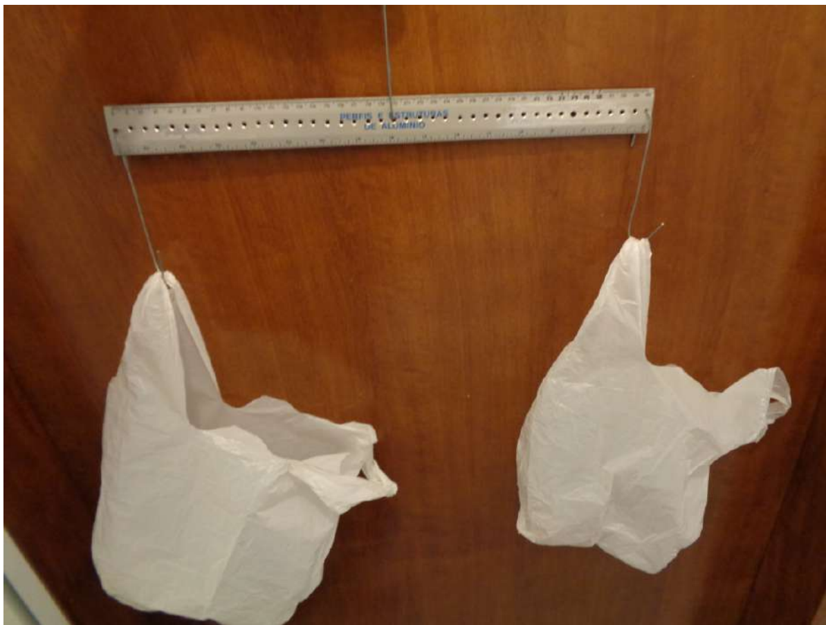
Figura 34 – Balança feita com uma régua, pedaços de arame e sacolas plásticas
