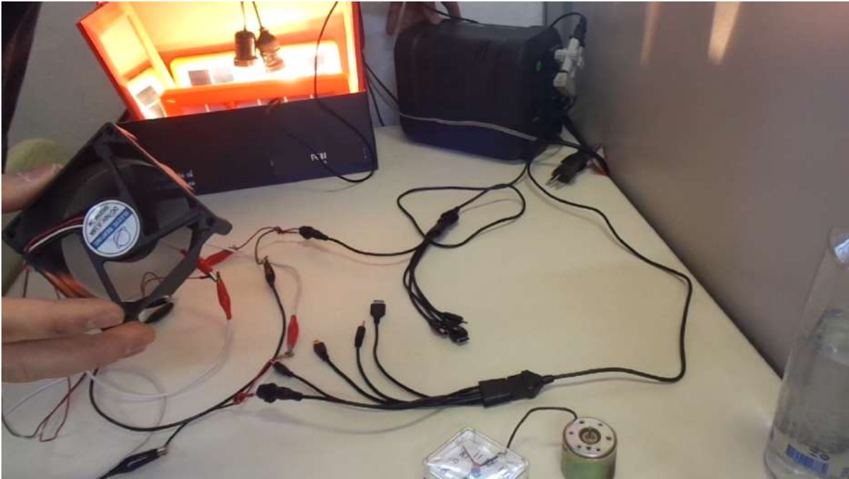
Figura 43 – Ventoinha sendo alimentada por módulos fotovoltaicos
