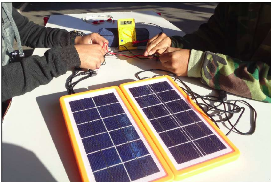
Figura 97 – Experimento de associações de módulos fotovoltaicos
