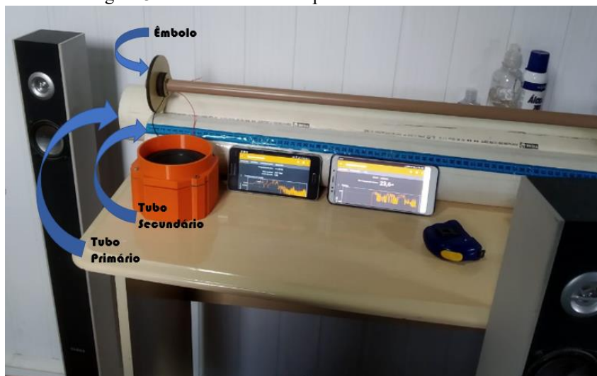
Figura 3.11 – Materiais do experimento de tubos sonoros
