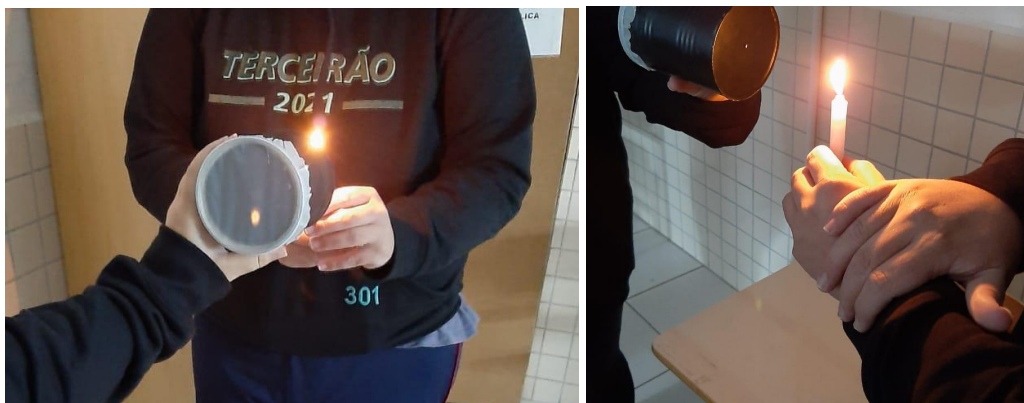
Figura 42: Observação da imagem invertida da chama da vela projetada na câmara escura
