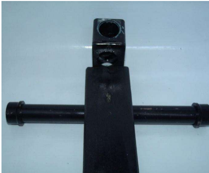
Figura 44 - Fixação da caixa do condutele na base.
