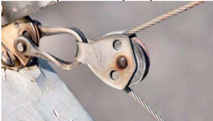
Figura 73 - Polia simples com uma corda passado pelo sistema de fixação.
