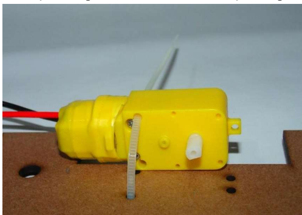
Figura 5 - Braçadeira plástica no local de fixação na parte frontal.
