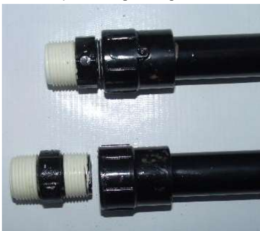
Figura 48 - Colocação das nípel rosqueável aos adaptadores.
