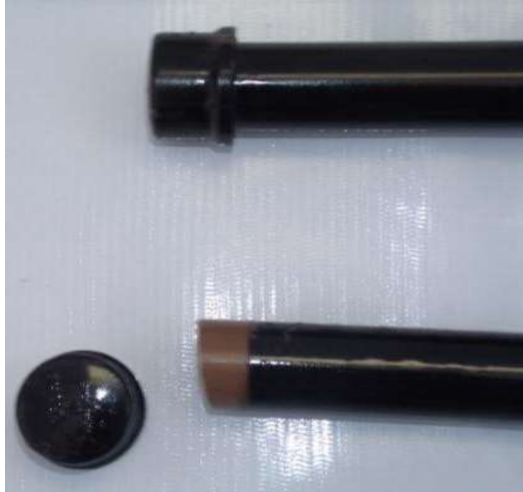
Figura 36 - Colocação dos tampões nos canos.
