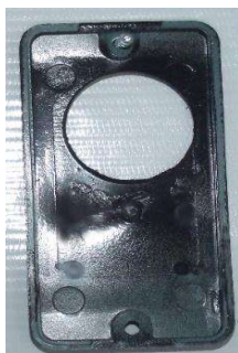
Figura 41 - Tampa do condutele com furo.
