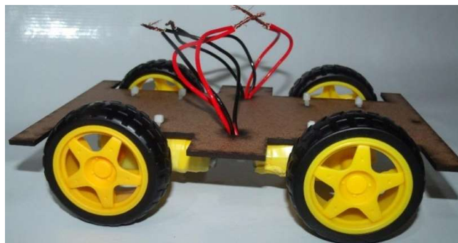
Figura 13 - Colocação das rodas.
