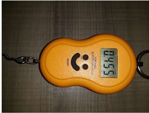
Figura 71 - Visor da balança com a tração do carrinho.
