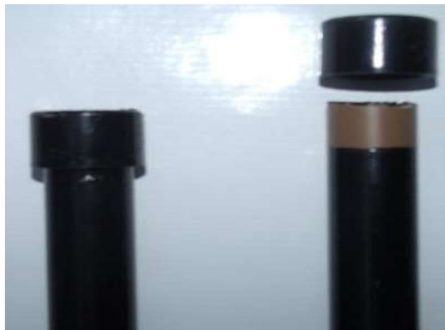
Figura 46 - Colocação das buchas de redução nos canos.
