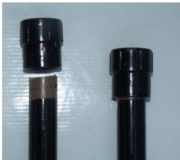
Figura 47 - Colocação dos adaptadores ao cano.
