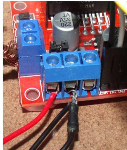
Figura 25 - Esquema de ligação do clip de bateria com a ponte H.
