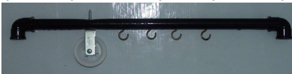
Figura 57 - Parte superior com roldã fixa e gancho de rosqueáveis de ancoragem.
