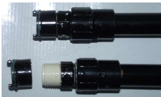
Figura 49 - Colocação dos adaptadores do condutele as nípel rosqueável.
