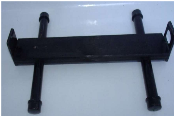
Figura 43 - Fixação das tapas do condutele na base.
