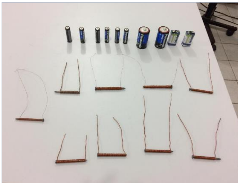
Figura 19 - Solenoides construídos na atividade experimental sobre eletroímã
