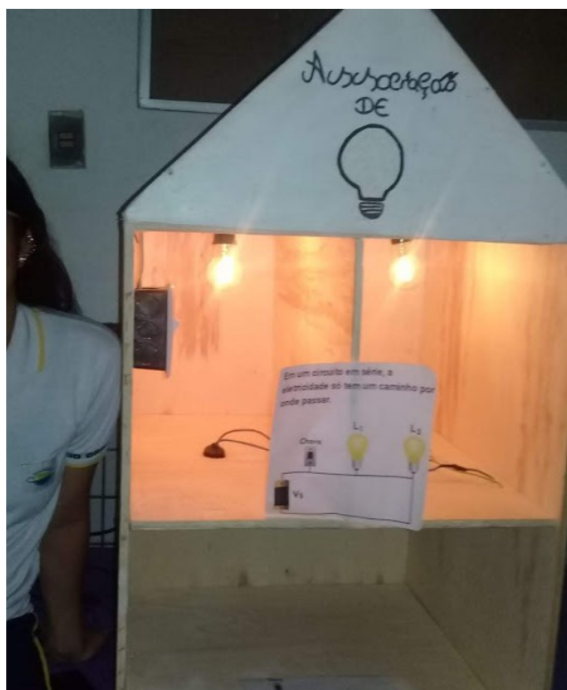
Figura 23 - Ligação de lâmpadas em série desenvolvida pelos alunos
