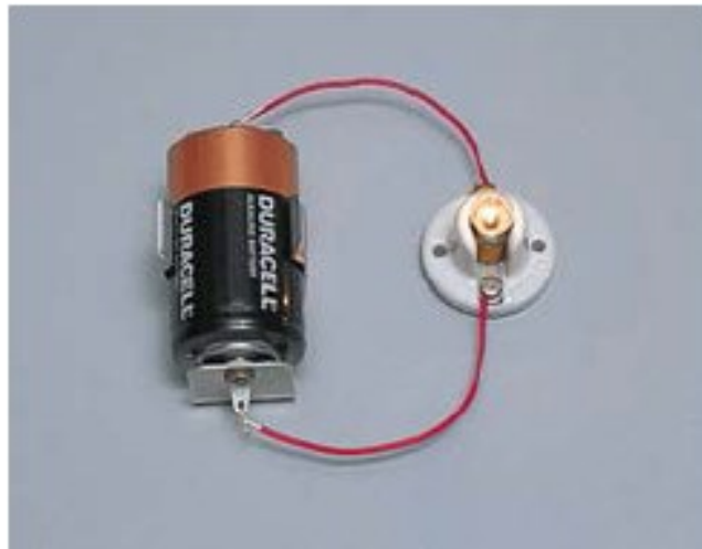
Figura 2 - Um condutor, sob diferença de potencial, sendo percorrido por uma corrente elétrica
