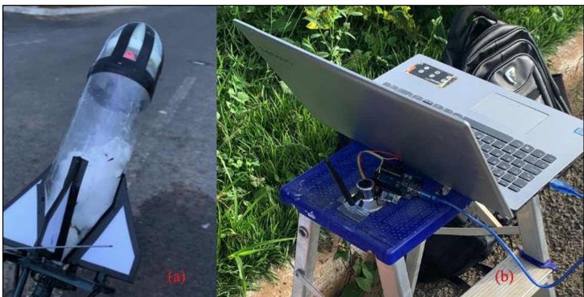
Figura 8. Utilização do kit experimental na aplicação do produto educacional. (a) emissor na coifa do foguete; (b) receptor
