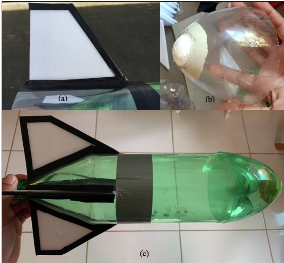
Figura 2. Componentes do foguete de Garrafa PET. (a) Aleta; (b) Coifa; (c) Foguete
