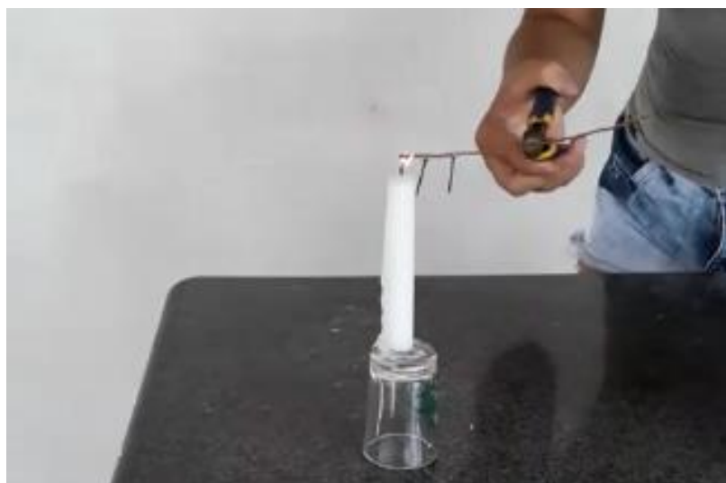
Figura 52 - Verificando experimentalmente a condutibilidade térmica.
