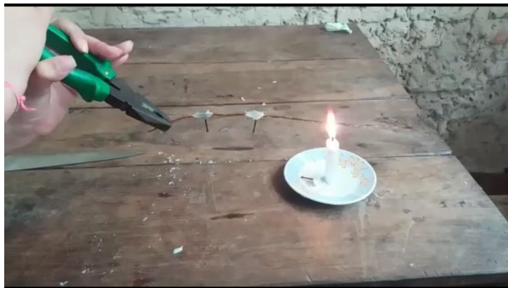
Figura 32 – Impressão do vídeo de uma aluna realizando o experimento de condução térmica.
