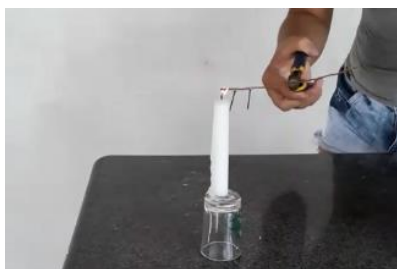
Figura 18 - Verificando experimentalmente a condutibilidade térmica.
