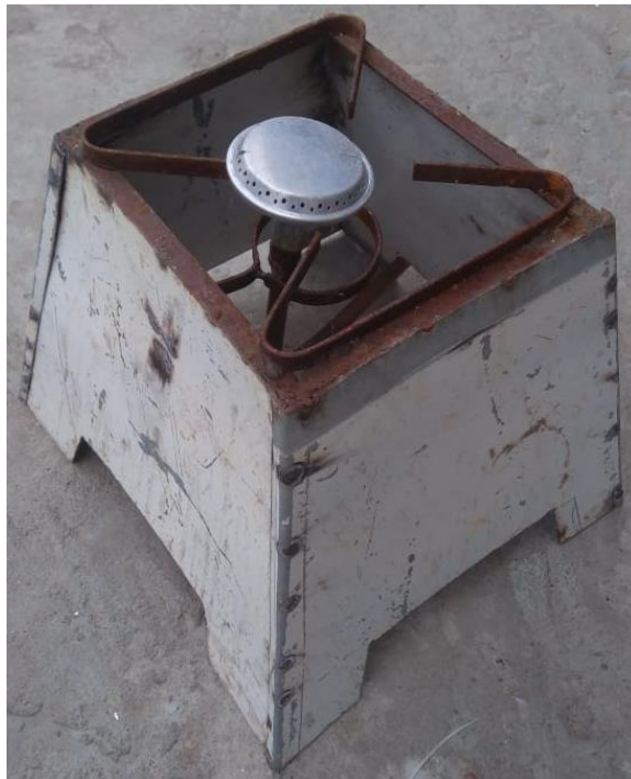
Figura 23 - Espiriteira à gás butano com válvula de regulagem e um tubo de zinco 10 cm X 70 cm usado para condução do calor entre a espiriteira e o interior do balão.
