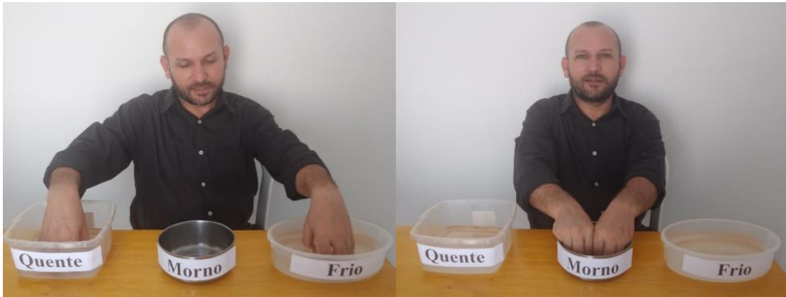
Figura 28 – Experimentando as sensações térmicas: misturando água “quente” com água “fria”. Após um certo tempo temos o equilíbrio térmico, se as quantidades forem proporcionais teremos água morna.
