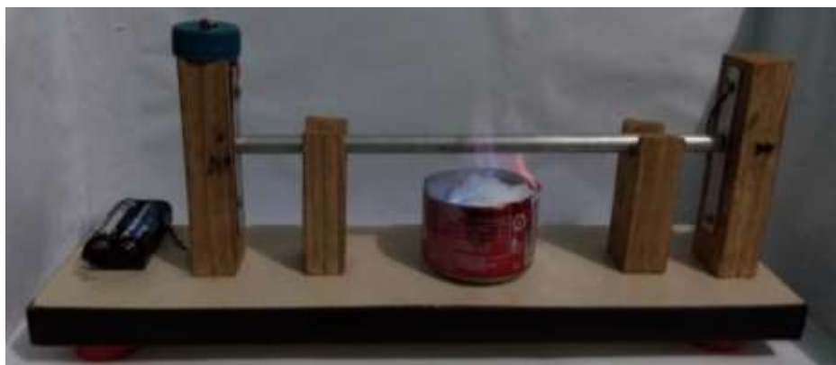
Figura 07a: Fonte de calor colocada abaixo da barra de alumínio. Fonte: Arquivos do Autor.
