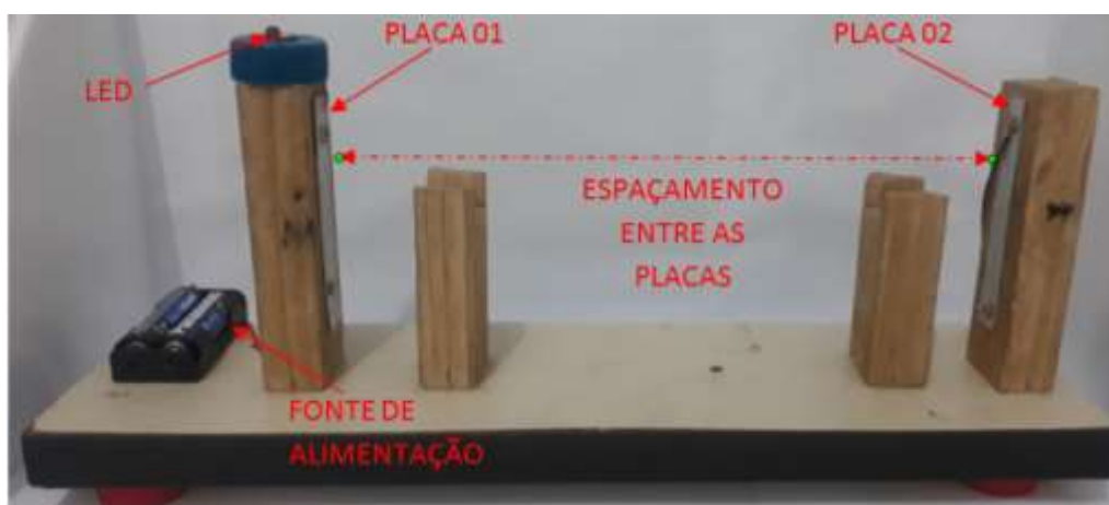
Figura 05: Imagem mostrando o espaçamento entre as placas, LED e fonte de alimentação do circuito elétrico contido no experimento 01. Fonte: Arquivos do autor.
