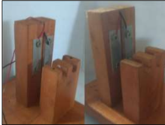
Figura 07: Circuito elétrico fixado nas placas de alumínio. Fonte: Arquivos do autor.
