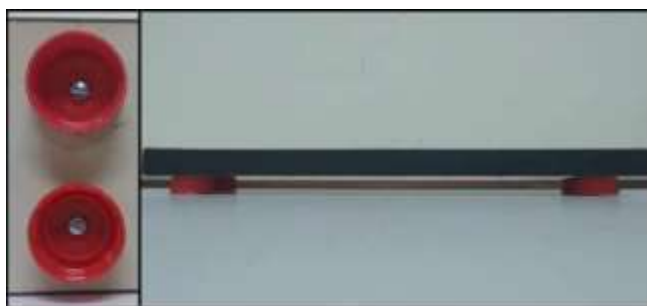
Figura 02: Base de apoio da estrutura de madeira. Fonte: Arquivos do autor.
