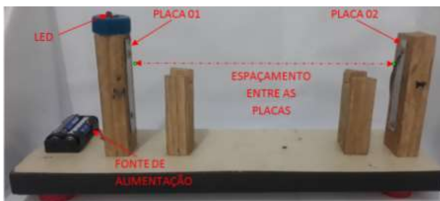
Figura 7: Imagem mostrando o espaçamento entre as placas, LED e fonte de alimentação do circuito elétrico contido no experimento 01. Fonte: Arquivos do autor.
