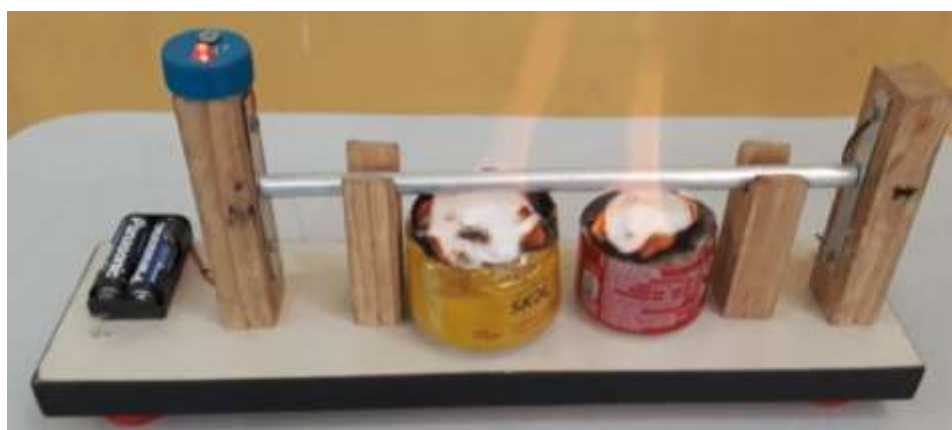
Figura 16: As duas fontes de calor, maior e menor, colocadas ao mesmo tempo abaixo da barra no experimento 01. Fonte: Arquivo do autor.
