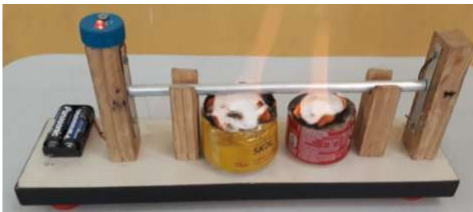
Figura 22: As duas fontes de calor, maior e menor, colocada ao mesmo tempo abaixo da barra no experimento 01. Fonte: Arquivo do autor.
