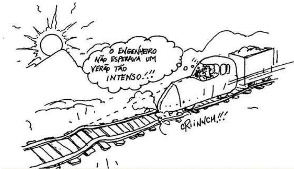
Figura 03: Trilhos de trem sofrendo dilatação devido a longa exposição aos raios solares.
