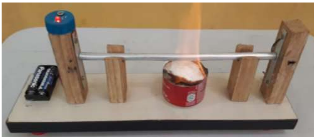
Figura 20: Fonte de calor menor colocada abaixo da barra no experimento 01. Fonte: Arquivo do autor.
