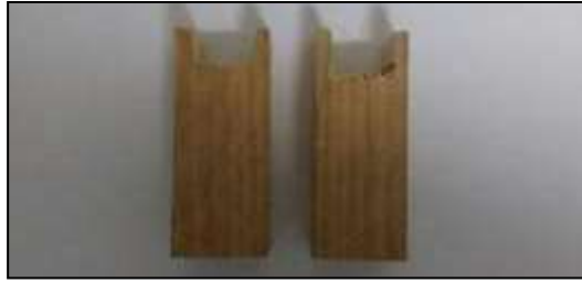
Figura 04: Ranhuras feitas nos blocos 3. Fonte: Arquivo do autor.
