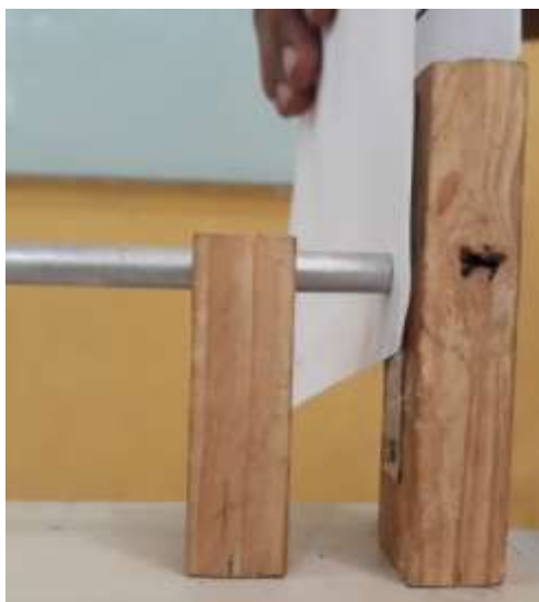
Figura 11: Folha de papel A4 demonstrando que a barra de alumínio não é suficientemente grande para fechar o circuito elétrico. Fonte: Arquivos do Autor.
