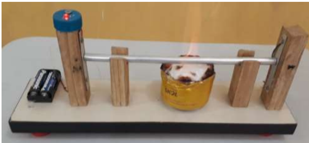
Figura 15: Fonte de calor maior colocada abaixo da barra no experimento 01. Fonte: Arquivo do autor.
