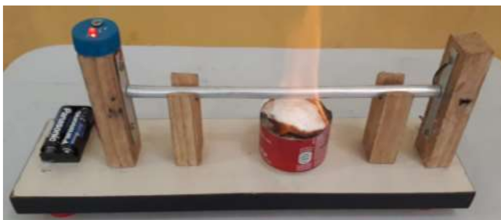
Figura 14: Fonte de calor menor colocada abaixo da barra no experimento 01. Fonte: Arquivo do autor.
