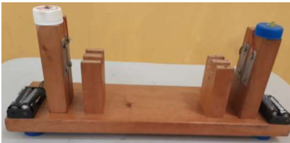
Figura 13: Dilatador linear duplo de baixo custo. Fonte: Arquivos do autor.
