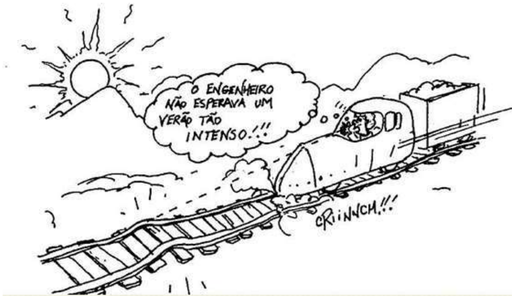
Figura 5: Trilhos de trem sofrendo dilatação devido a longa exposição aos raios solares.
