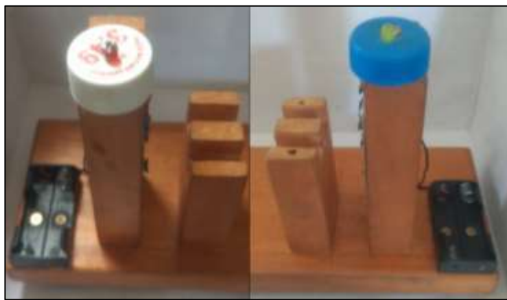
Figura 08: Base de apoio para o LED feita de tampa de garrafa PET. Fonte: Arquivos do autor.
