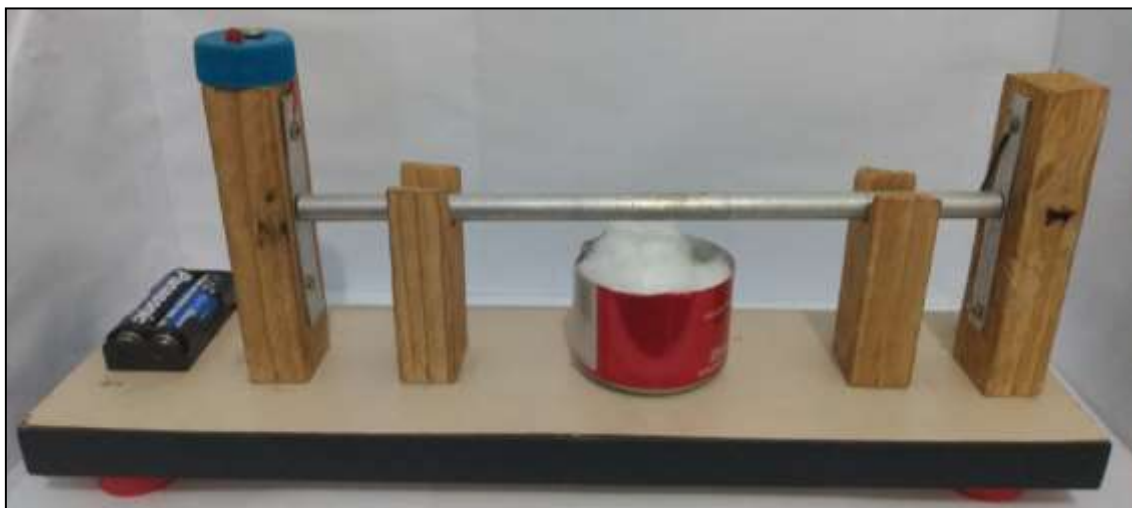
Figura 6: Montagem final do experimento “Dilatador linear de baixo custo”. Fonte: Arquivos do autor.
