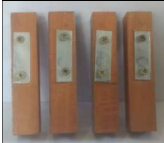
Figura 03: Placas de alumínio fixadas nos blocos 2. Fonte: Arquivos do autor.
