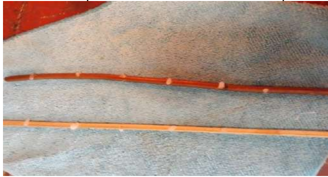
Figura 16 – barra de cobre e palito de churrasco usados da experiência de condução
