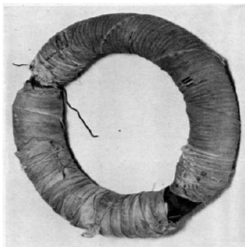
Figura 3: Anel de ferro original construído por Faraday.
