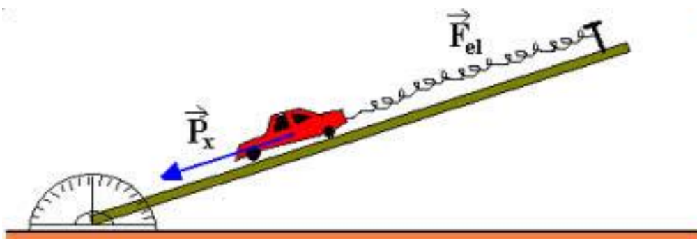
Figura 3. Experimento de atrito no plano inclinado
