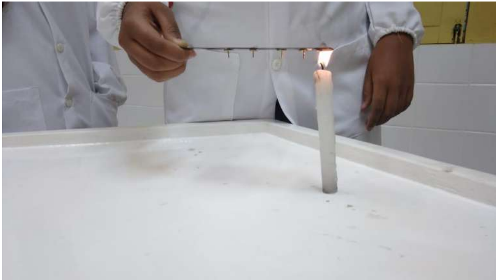
Figura 31 - Realização do experimento de condução térmica. (Fonte: Arquivos do Autor).
