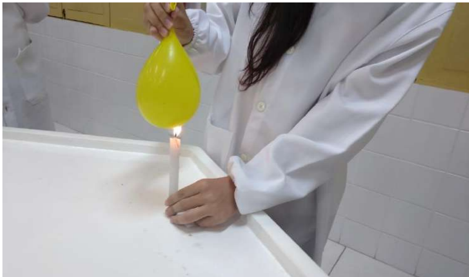
Figura 32 - Realização do experimento sobre calor específico. (Fonte: Arquivos do Autor).
