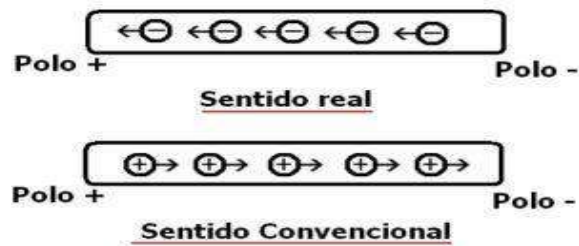
Fig. 6. Sentido real e convencional da corrente elétrica
