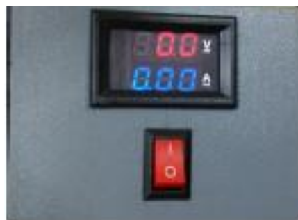
Figura 31- Display do voltímetro e amperímetro digital
