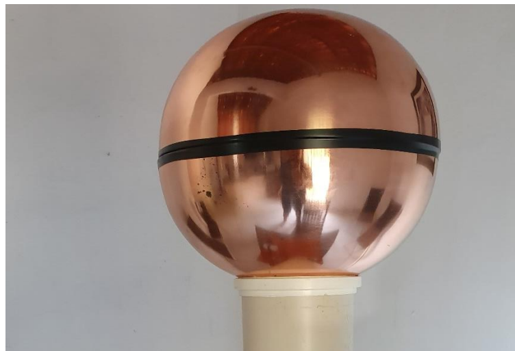
Figura 44: Cúpula de descarga já posicionada na coluna de apoio do GVDG. Autoria própria.
