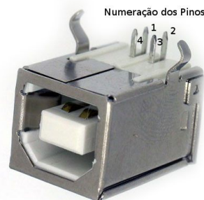
Figura 32 - Número dos pinos do conector USB.
