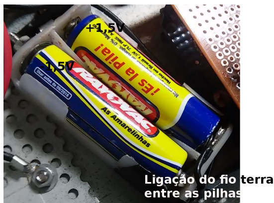
Figura 48 - Fonte simétrica 1,5V com duas pilhas.
