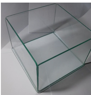
Figura 8 - Caixa de proteção com 16 cm de aresta.
