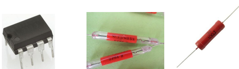
Figura 4 - Amplificador CA3420 e resistor 10 G \Omega .
