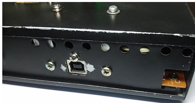
Figura 66 - Detalhe da chapa metálica tirada da impressora que cedeu a USB
