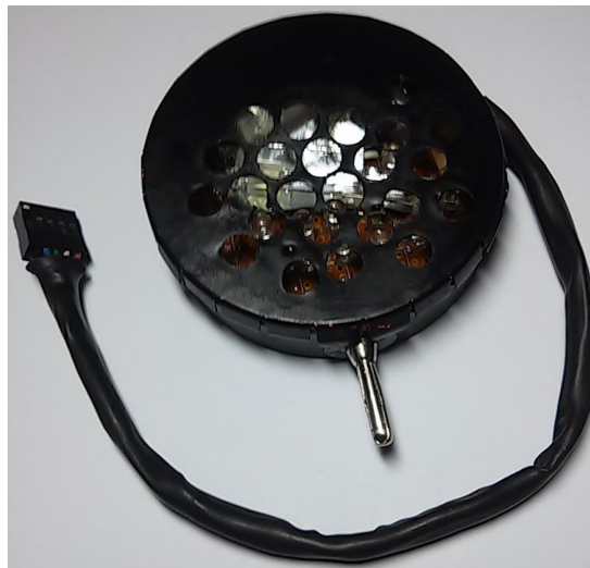
Figura 38 - Caixa metálica das lâmpadas
