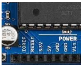
Figura 13 - Detalhe dos pinos de alimentação Arduino Uno.
