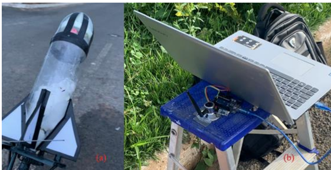
Figura 24. Utilização do kit experimental na aplicação do produto educacional. (a) emissor na coifa do foguete; (b) receptor
