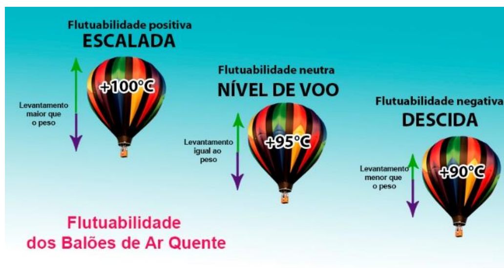
Figura 2 - Exemplos de flutuabilidade dos balões com a variação da temperatura. As mudanças de temperatura do ar no interior de um balão determinarão se ele sobe, desce ou se mantém estável.
