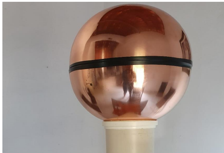
Figura 30: Cúpula de descarga já posicionada na coluna de apoio do GVDG. Autoria própria.
