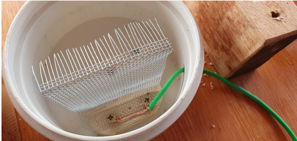
Figura 32: Cap inferior para encaixe da colina de apoio, já com a escova metálica instalada.
