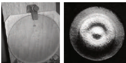
Figura 1: Superfície do vidro esmerilhado observada a olho nu e superfície do vidro esmerilhado observada no dispositivo de Foucault.
