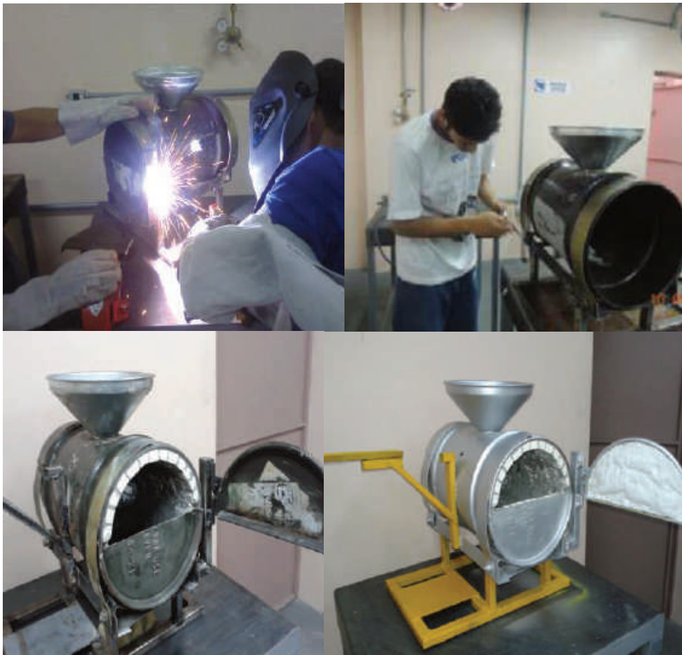
Figura 2. Etapas de construção e acabamento do forno.
