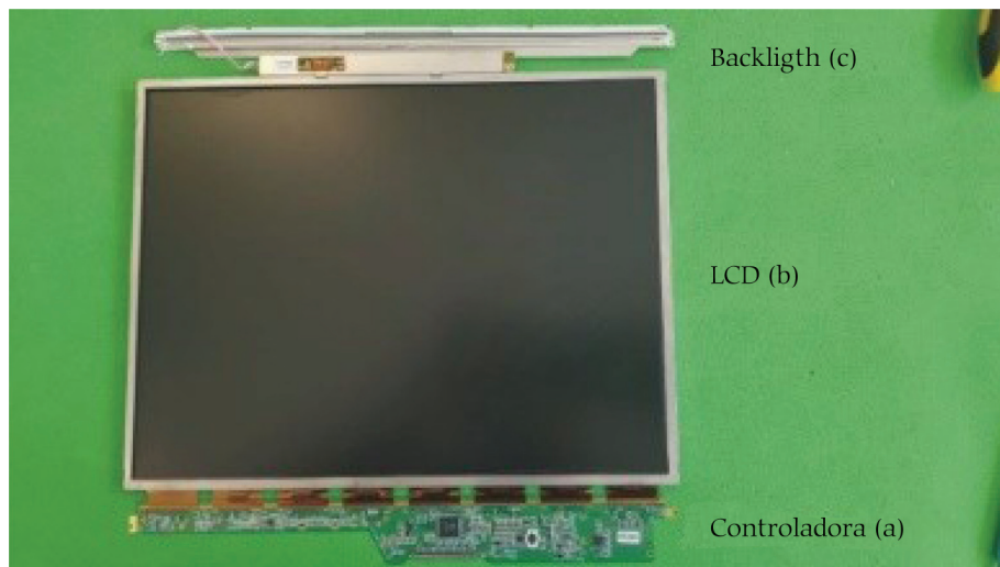
Figura 1: A figura mostra uma tela de LCD para retirada dos filmes polarizador e difrator.
