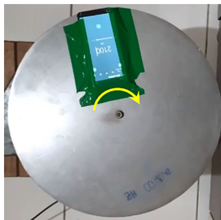
Figura 8 - Fonte emissora fixada na base giratória.
