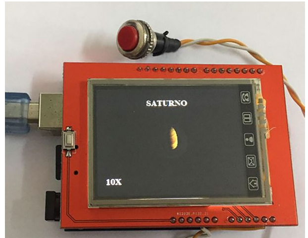
Figura 1 - Arduino Uno com display LCD mostrando a imagem de Saturno, com ampliação aparente de 10x.
