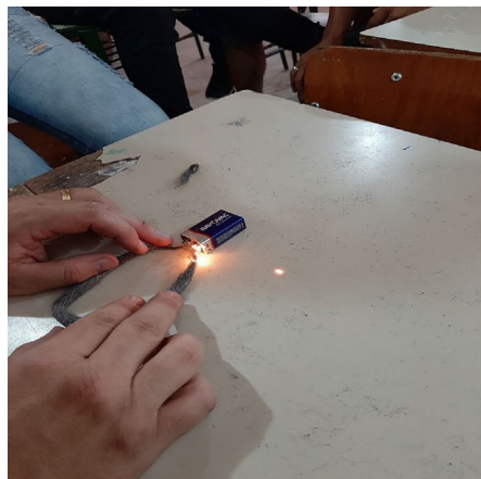
Figura 5 - Encostando a palha de aço nos polos da bateria (esquerda) e palha de aço pegando fogo (direita).
