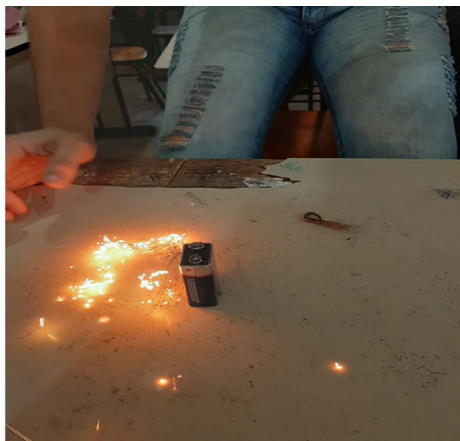
Figura 5 - Encostando a palha de aço nos polos da bateria (esquerda) e palha de aço pegando fogo (direita).
