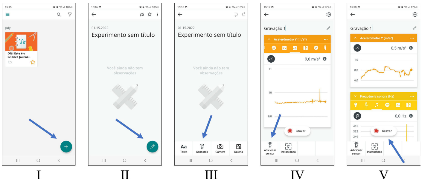
Figura 3 - Esquemática de como aferir as grandezas do experimento através do ASJ.
