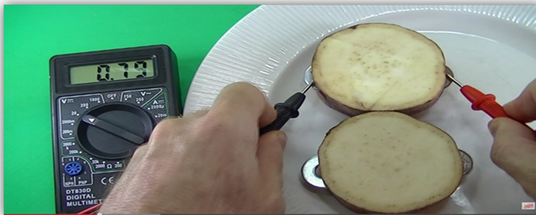
Figura 6 - Diferença de potencial entre os polos, sem solução de vinagre
