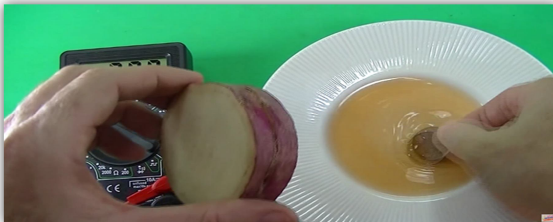
Figura 7 – a moeda de cobre e a arruela de zinco embebidas na solução de vinagre
