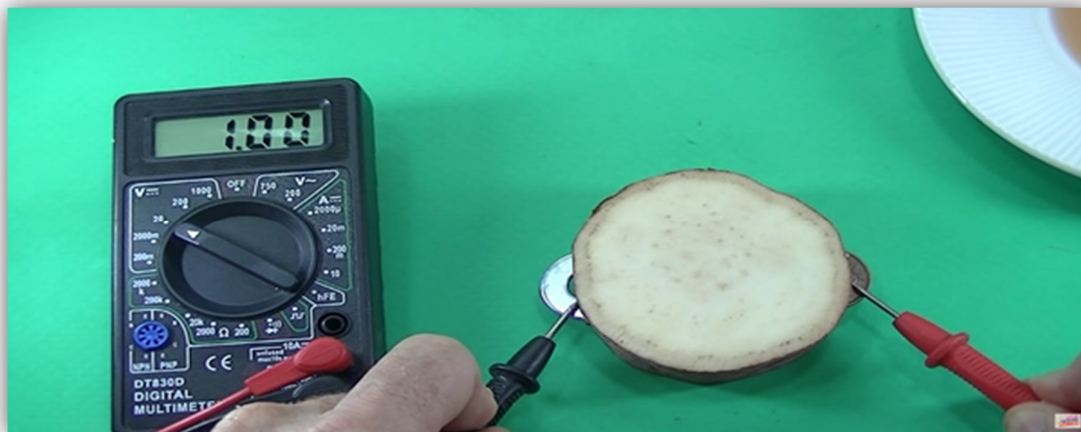
Figura 8 - com a solução de vinagre a diferença de potencial aumenta
