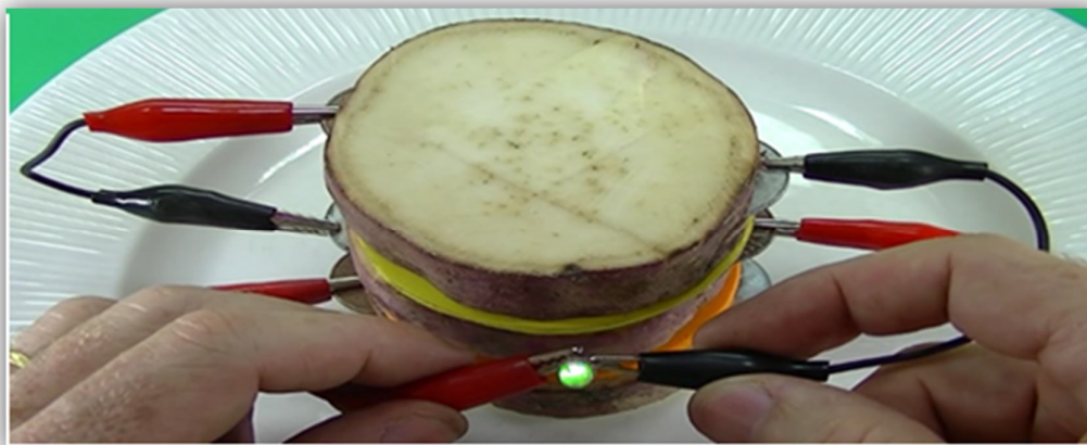
Figura 5 – Experimento: a pilha de batata doce
