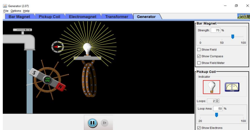
Fig. 24. Simulação Phet ilustrando a relação entre a frequência de giro do ímã e a intensidade do brilho da lâmpada
