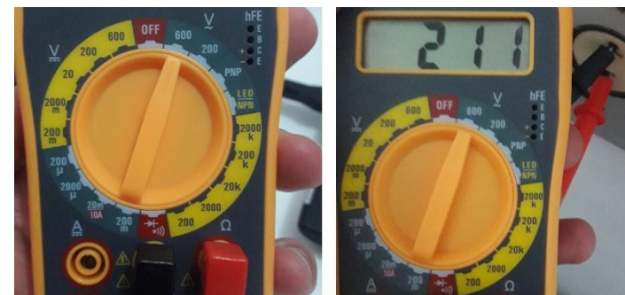
Figura 5.2: Medindo tensão de uma rede 220V em corrente alternada
