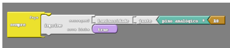
Figura 5.16: Estrutura de programação para fazer a leitura dos dados pelo monitor serial.
