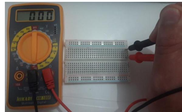
Figura 5.7: Medindo resistência elétrica
