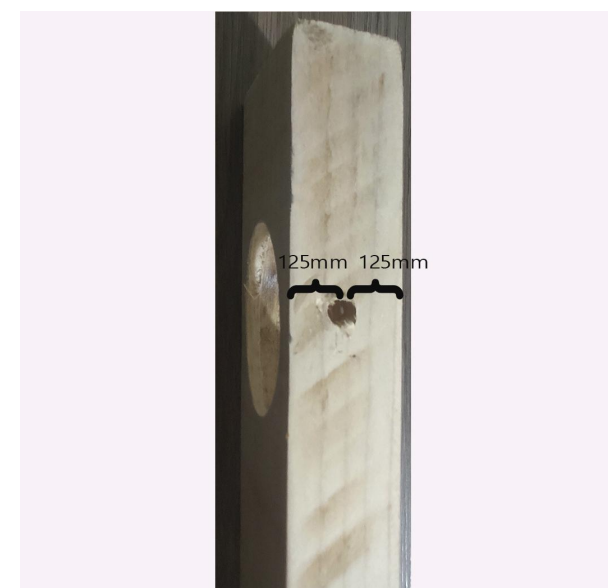
Figura 7.17- Vista do furo lateral.
