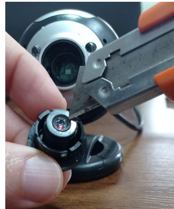
Figura 6.17: Remoção do filtro infravermelho.
