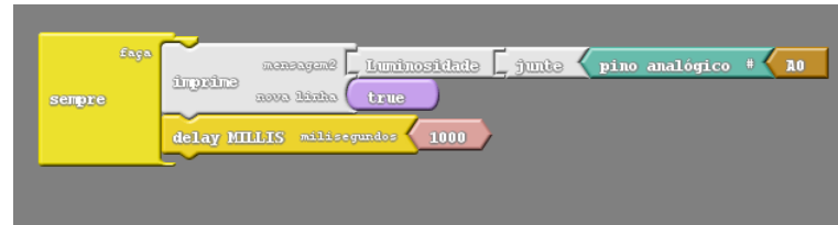
Figura 5.20: Exemplo de programação utilizando Ardublock
