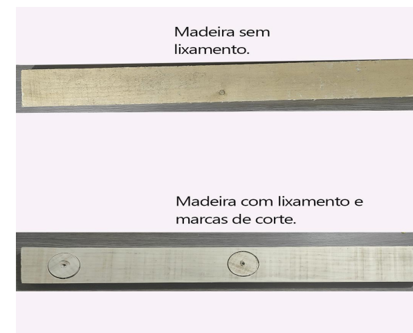
Figura 7.14. Comparação da madeira sem e com o lixamento.
