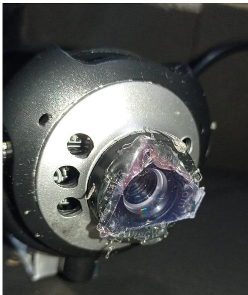
Figura 6.18: Rede de difração colada na entrada de luz da webcam..
