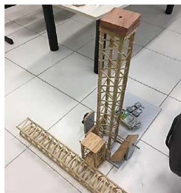
Figura 64. Estruturas nas etapas finais de secagem.
