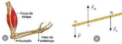
Figura 6: (a) O antebraço é mantido na posição indicada pela ação da força do biceps no ponto C. A carga a ser suportada é o peso do antebraço que se aplica no CG. O sistema funciona como uma alavanca interpotente. Em (b) temos o DCL da alavanca (antebraço reduzido a uma alavanca), onde F_M é a força do biceps e F_R é o peso do antebraço (a resistência a ser vencida).
