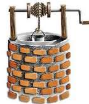
Figura 8: Sarilho usado para erguer balde com água do interior de uma cisterna com água.
