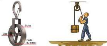
Figura 7: (a) Características principais de uma polia móvel ou roldana. (b) Polia móvel em operação: erguer a carga puxando o fio para baixo é mais cômodo do que erguê-la puxando-a diretamente para cima.
