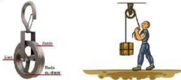
Figura 7: (a) Características principais de uma polia móvel ou roldana. (b) Polia móvel em operação: erguer a carga puxando o fio para baixo é mais cômodo do que erguê-la puxando-a diretamente para cima.
