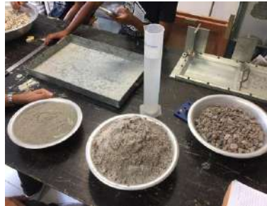
Figura 71. Mistura dos componentes da concretagem.
