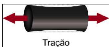
Figura A.1: representação da aplicação de uma tensão axial aplicada em uma barra
