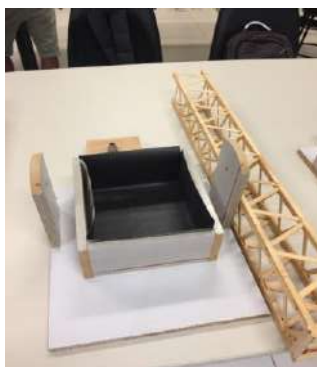
Figura 67. Base para a concretagem com vedação improvisada.
