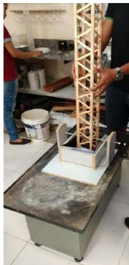
Figura 72. Plataforma vibratória-laboratório edificações IFPA.
