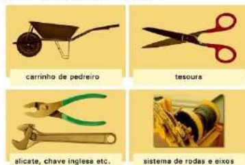
Figura 2: Alguns exemplos de máquinas compostas de máquinas simples.
