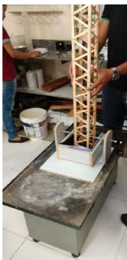
Figura 72. Plataforma vibratória-laboratório edificações IFPA.
