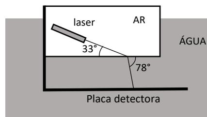
Em um rio nas margens de uma indústria química que fabrica essa resina, usa-se um equipamento flutuante contendo um laser em um recipiente transparente, conforme figura apresentada. Ao acionar o equipamento, ele liga o laser cuja luz atinge uma placa detectora. O equipamento faz a leitura e emite avisos de segurança conforme referência abaixo. Certo dia, esse dispositivo mostrou o caminho do raio de luz do laser conforme imagem.
